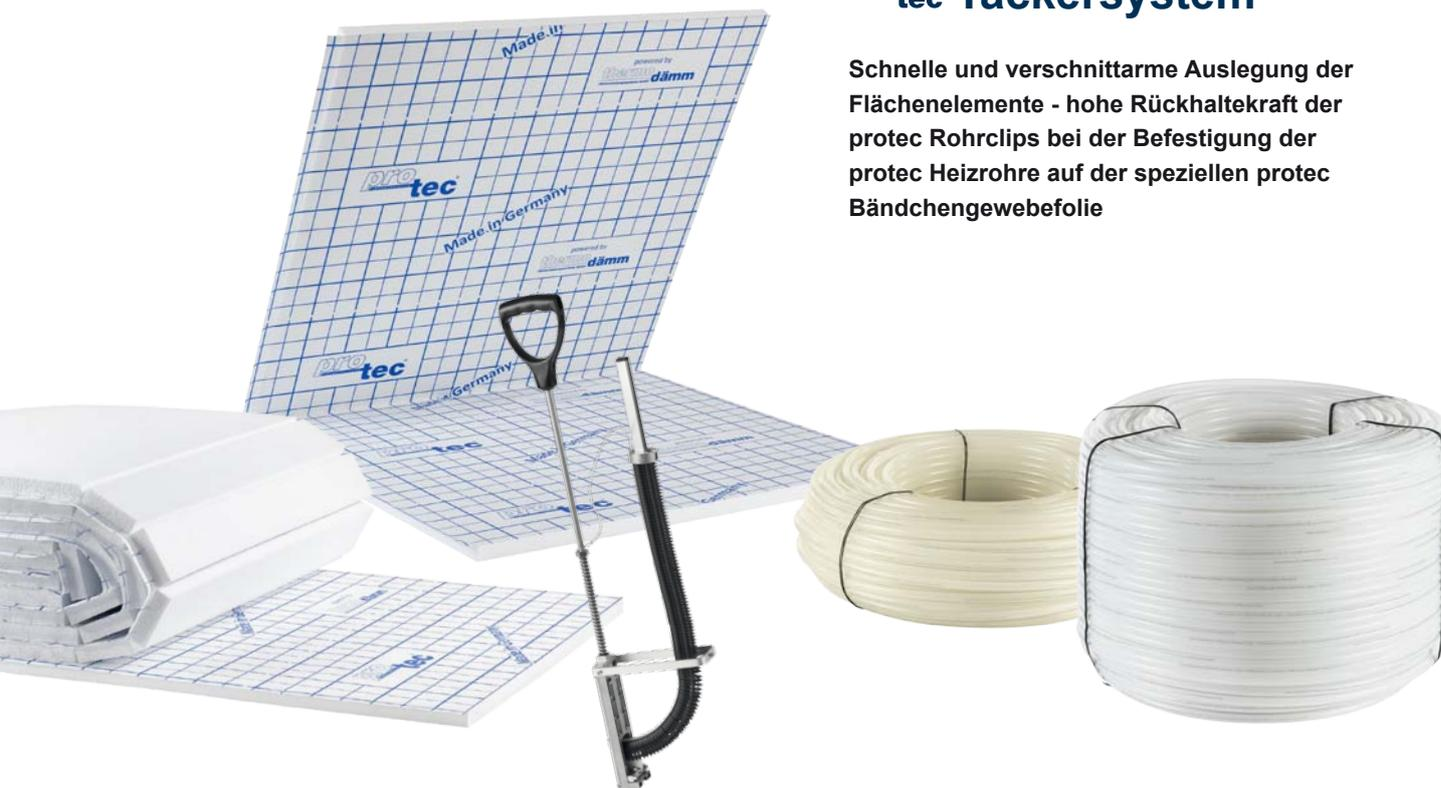
Die pro-tec Rollbahnen und Faltplatten mit aufkaschierter Bändchengewebebefolie sind die Grundelemente des Tackersystems. Sie dienen zur Wärmedämmung sowie als Rohrträgerelemente. Die auf der Folie aufgedruckte Rasterung ermöglicht das Ausrichten der Heizrohre auf der Fläche, die dann mittels der pro-tec Rohrclips sicher in der pro-tec Bändchengewebebefolie arretiert werden.
