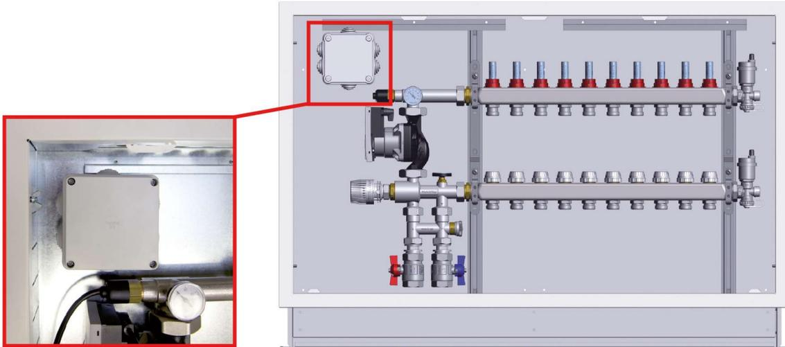
Die Pumpensteuerung stellt sämtliche zum Betrieb der Regelgruppe benötigten Anschlüsse bereit: Freigabe Heizkessel (NO), Raumthermostat (TA), Sicherheitsthermostat (TS) und Stromversorgung der Umwälzpumpe (POMPA). Die Schaltplatine wird mit 230 V spannungsversorgt.
