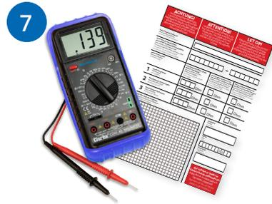
Der Ohm-Standardwert darf max. 10 % abweichen. Messen Sie auch zwischen Widerstandskabel und Erdungsmantel. Bei dieser Messung darf der Zeiger nicht ausschlagen.
